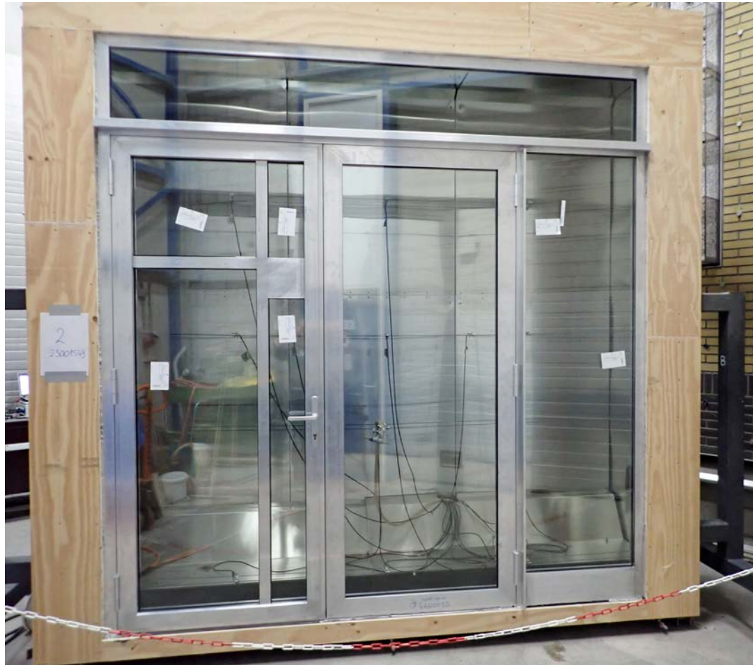
Testopstelling rookwerendheidsbeproeving EN 1634-3 bij SKG-IKOB in Geldermalsen
